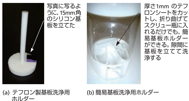
図 3-4 基板洗浄ホルダー
